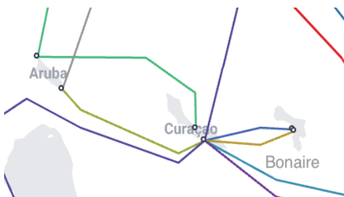
Figuur 3.1: Connectiviteit Bonaire. Op de onderzeekabelkaart is te zien dat Bonaire alléén verbonden is met Curaçao. Dit zorgt voor een grote afhankelijkheid van Curaçao en diens voorzieningen. Vanuit Curaçao kan er via vergelijkbare kabels gecommuniceerd worden met Aruba, Zuid-Amerika en Noord-Amerika. De meest voorkomende en efficiënte route naar Europa gaat via Curaçao → Puerto Rico (VS) of de Britse Maagdeneilanden → Miami of Jacksonville (VS) → New York (VS) → Nederland (al dan niet via het Verenigd Koninkrijk).
