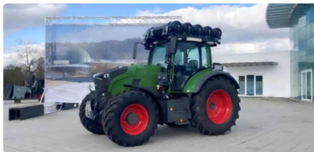
FIGUUR 3| Fendt tractor met waterstoftanks op het dak (bron: ©Fendt)
