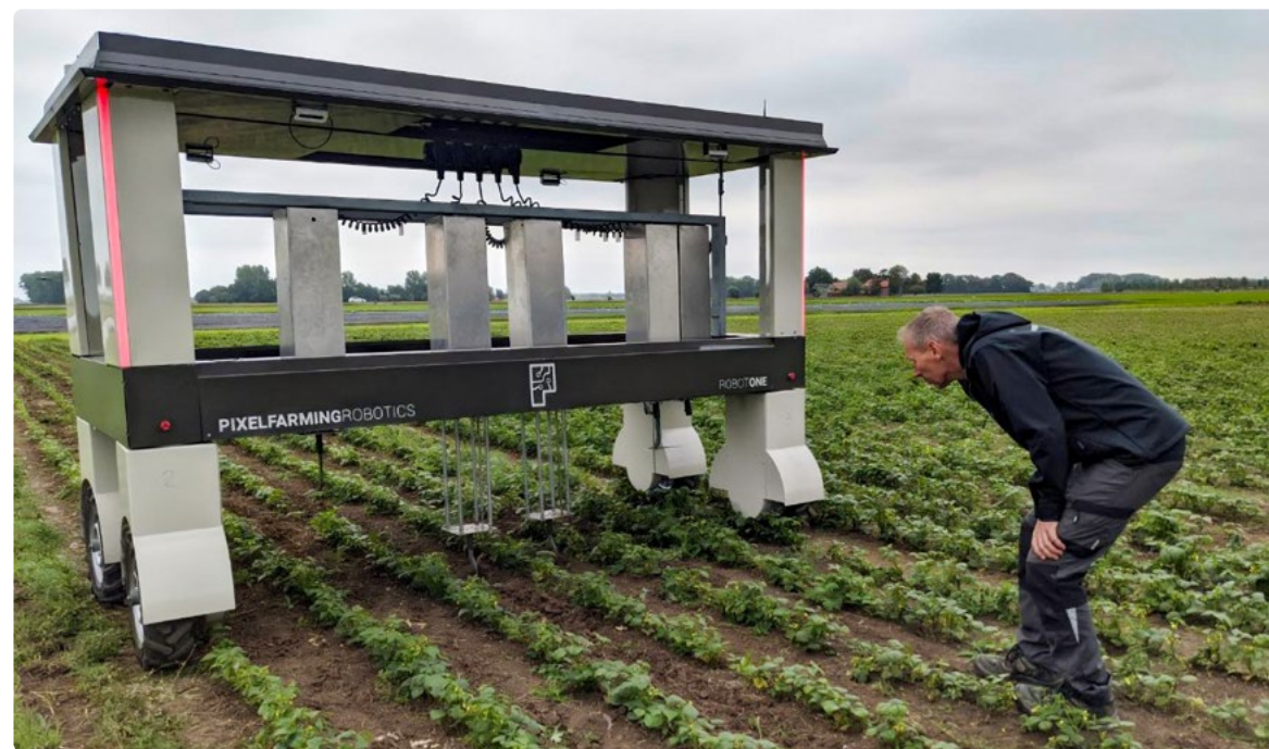
Pixelfarming Robotics (Almkerk in Nederland) heeft een robot gebouwd die kan wieden, snoeien, maaien en schoffelen.
