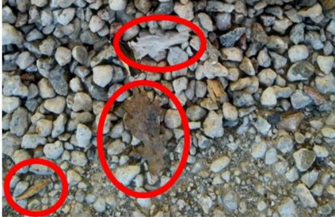
Foto: Betongranulaat (gradatie 4-16 mm) vervuild met hout en plastic
