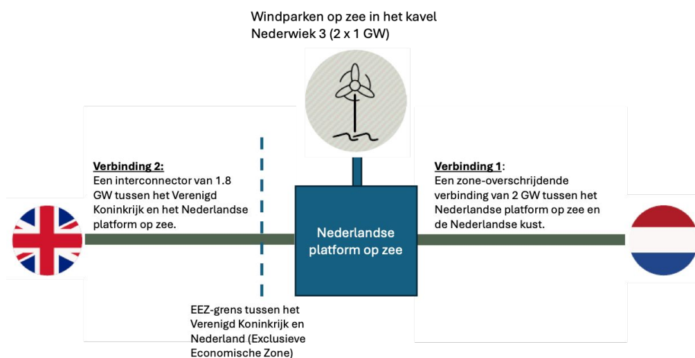
Figuur 1: opzet van de hybride interconnector, LionLink.
