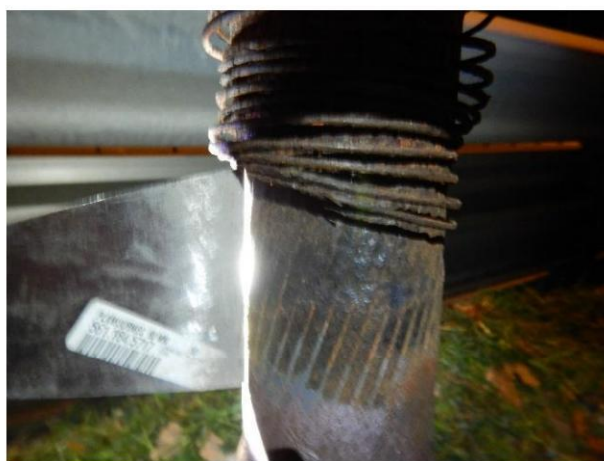
afbeelding 20: afname na het verwijderen van 7 mm roest
