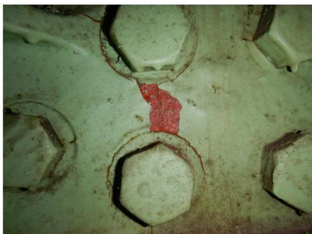
afbeelding 27: haarscheur in gietstuk (west-31)
