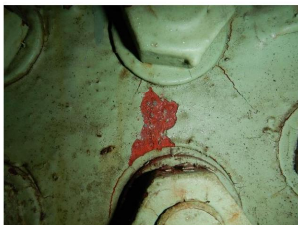
afbeelding 26: haarscheurtje in gietstuk (west-31)
