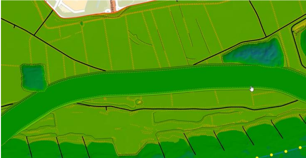
Figuur 5-3: De geul UG15 gaat door hoger liggende kades heen waardoor de uiterwaard eerder overstroomt.
