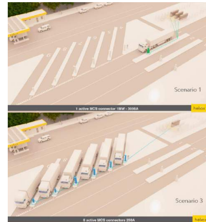
Figuur 5.6: Schematisch overzicht van modulaair opgebouwde laadinfrastructuur [85]
