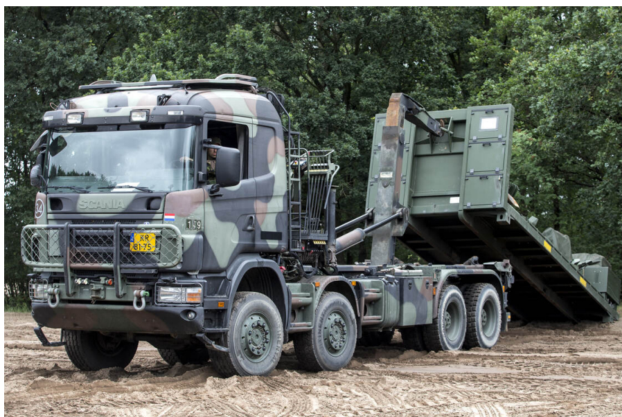
Afbeelding 2 Een vrachtwagen met flatrack. Dit is een open laadplatform zonder de zijwanden en het dak. Het is bedoeld voor deellevering van zware, afwijkende ladingen en pallets (bron: Defensie).
