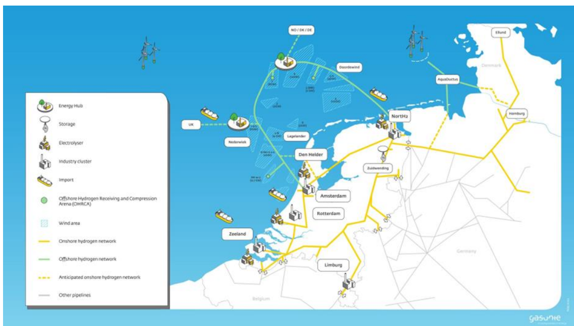
Figuur 2.7: Schematische weergave van het beoogde waterstofnetwerk op zee van HyNetwork Services (ref. 31).
