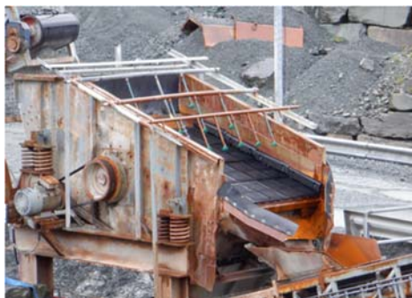
Seljestokken: 1 wasser met 3 buizen x ca 4 sproeiers
