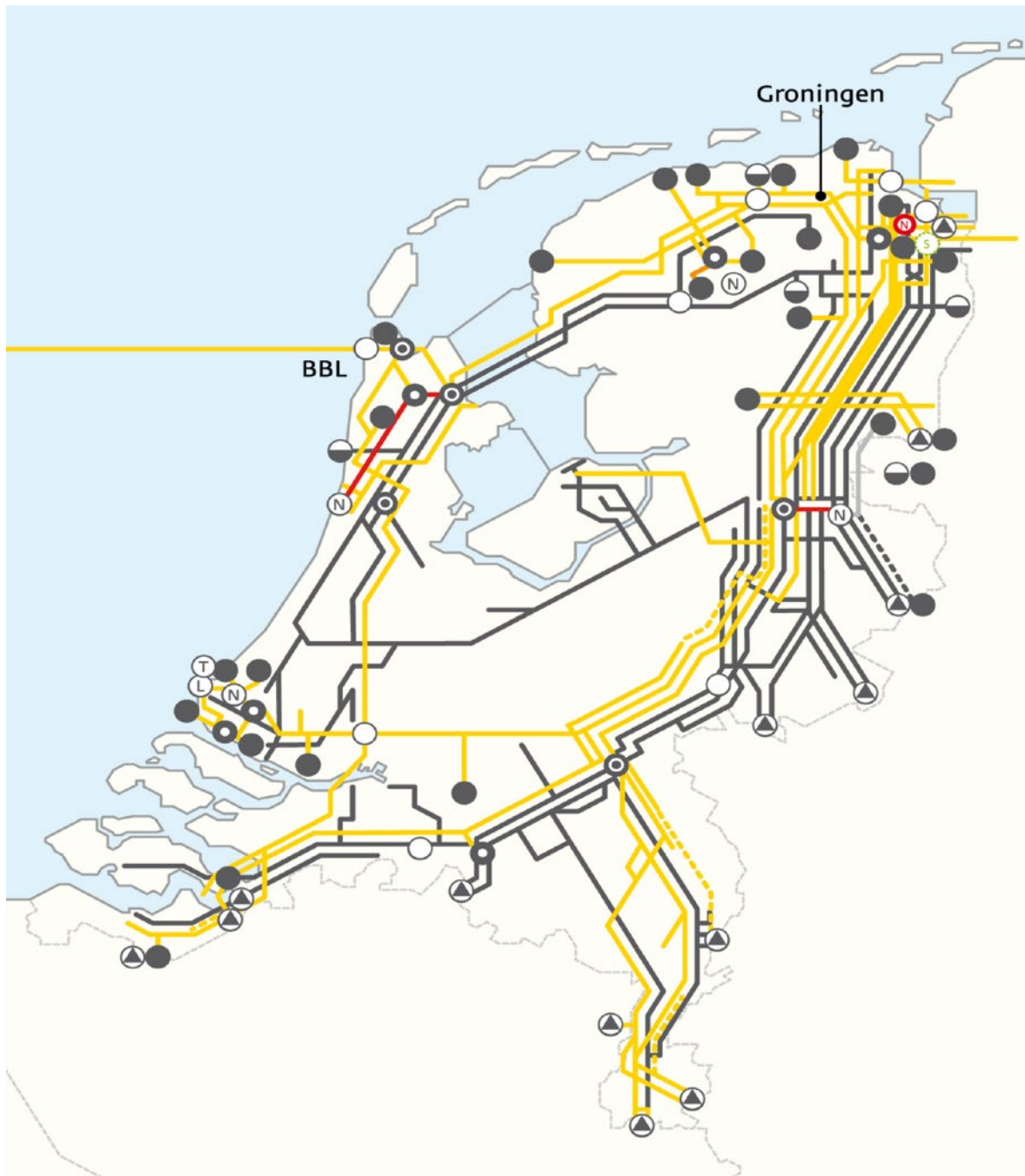
Figuur 4.12 Transmissienetwerk voor hoogcalorisch gas (geel) en Groningen gas (zwart) (Bron: GTS, 2022)
