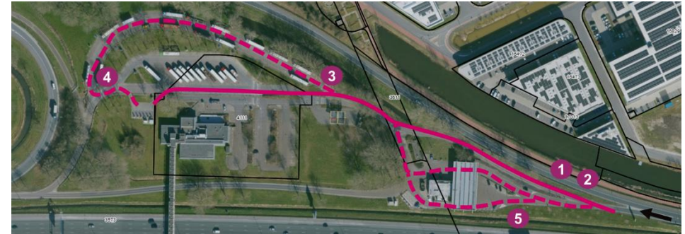
Figuur 4 Bovenaanzicht routes naar laadpunt Ionity. Veiligheidsrisico's: 1) Bebording, 2) Zichtbaarheid 3) bebording 4) Mogelijke route tegen de richting in formeel toegestaan 5) Onwenselijke aanrijroutes langs tankend verkeer
