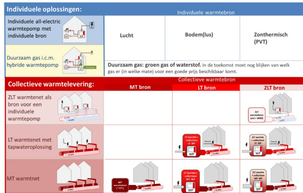
Figuur 6. Overzicht technische oplossingen voor verwarmen.
