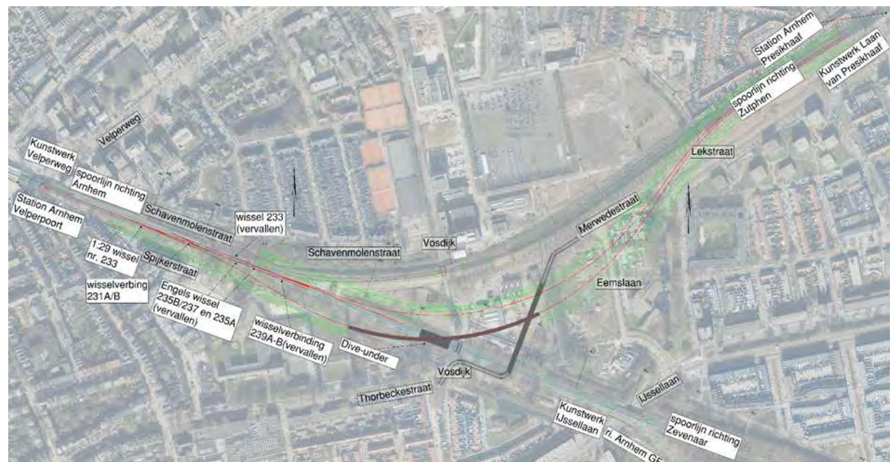
Figuur 4.12: bovenaanzicht oplossingsrichting 1
