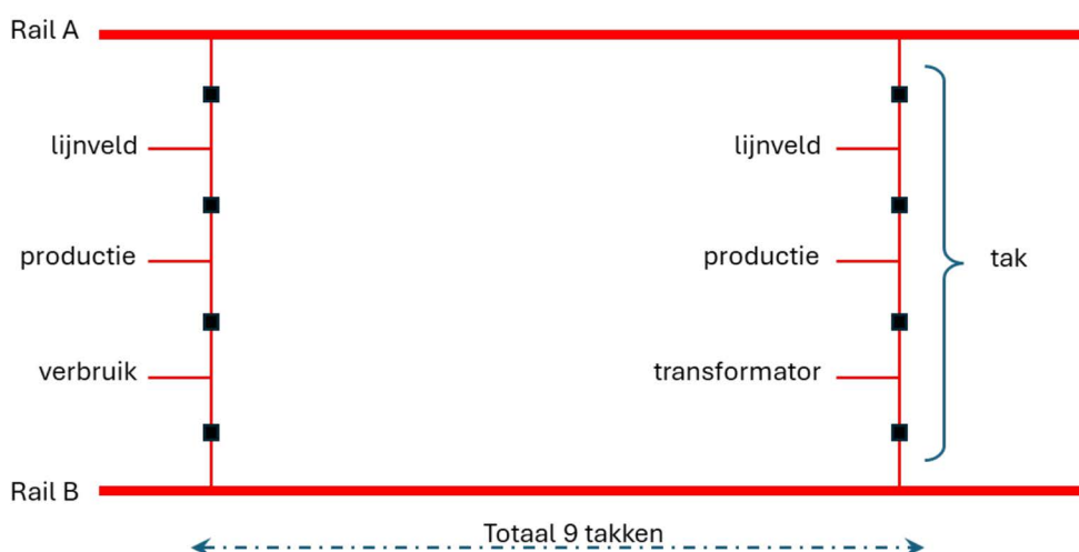
Figuur 9: Vereenvoudigde schematische weergave opbouw station EHO380
