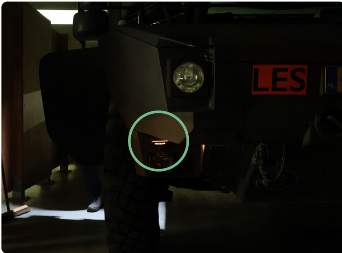
Figuur 8: Oorlogsverlichting rechtoverzijde Fennek lesvoertuig (groen omcirkeld, gefotografeerd in een loods, bron en bewerking: Onderzoeksraad voor Veiligheid).
