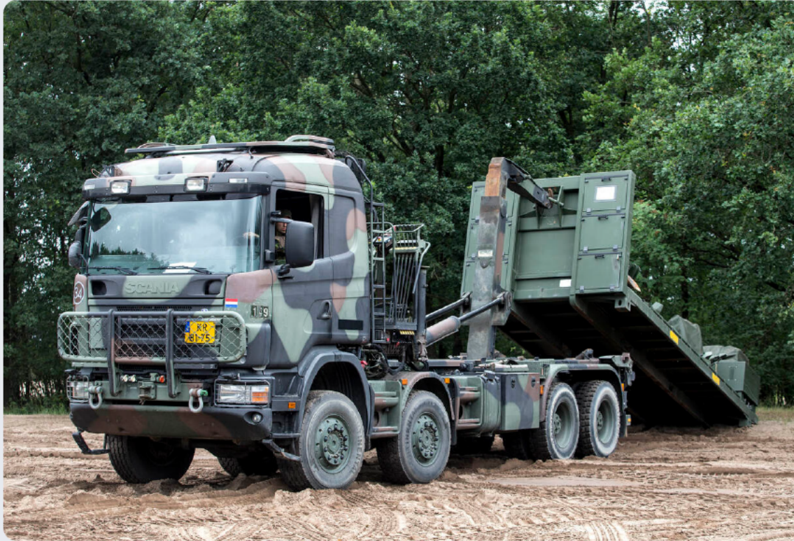
Figuur 12: Scania-wissellaadsysteem (bron: Ministerie van Defensie).
