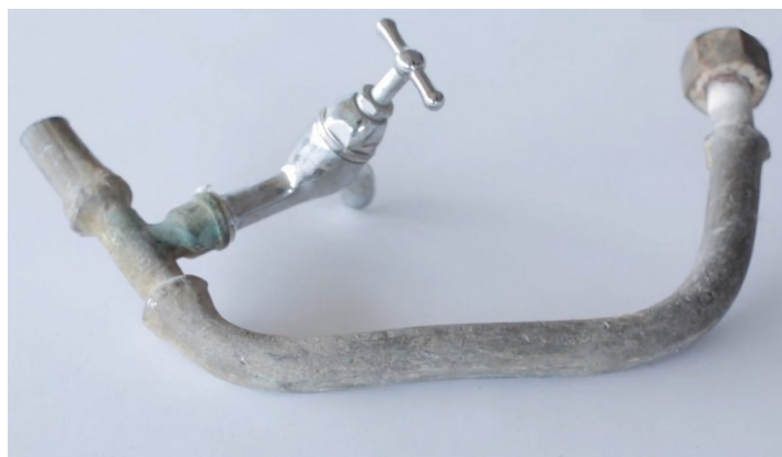
Figuur 3 : Loden leiding (bron: Drinkwaterplatform)
