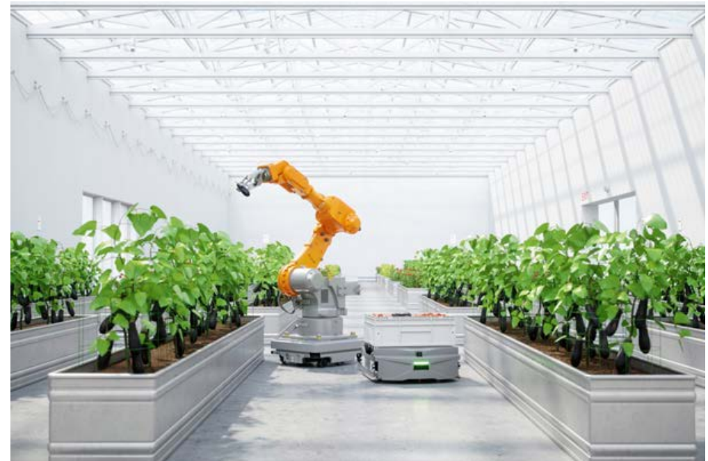
Figuur 2.4 Mobiele plukrobot
