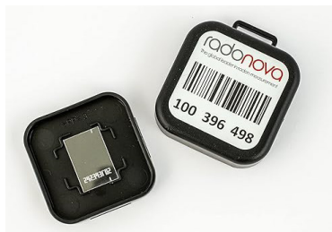
Figuur 3.1 Opengemaakte Radtrak 3 radonmeter. Figuur uit [19].
