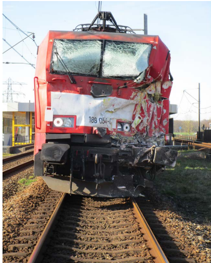
◀ Figuur 46: Foto van de voorzijde van de locomotief van trein 47612, het bovenste frontsein is afgedekt door een onderdeel van de kraan (zwart) dat onder een handgreep onder het raam is gekomen.
