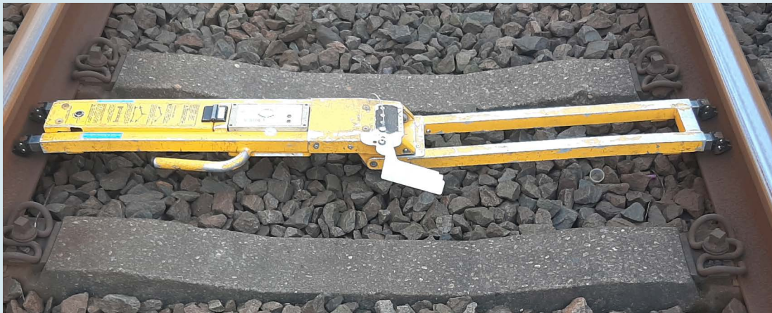
▲ Figuur 10: Zelfsignalerende kortsluitlans (in spoor 3 te Voorschoten)
