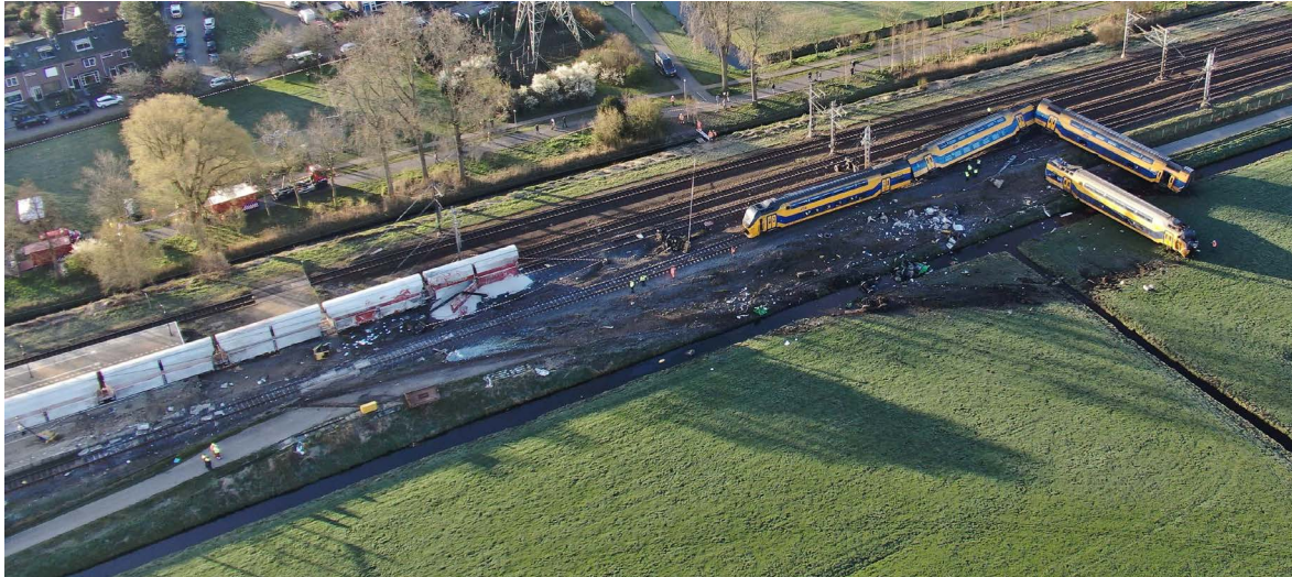
▲ Figuur 47: Overzichtsfoto van ongevalslocatie met links de vijf achterste wagen van de goederentrein, ter hoogte van de derde wagen van achteren ligt railinzetplaats met op de voorgrond de toegangsweg. Brokstukken van de kraan liggen verspreid over de ongevalslocatie, rechts staat de ontspoorde en gebroken reizigerstrein tussen beide treinen ligt het onderstel van de kraan. (bron: politie)
