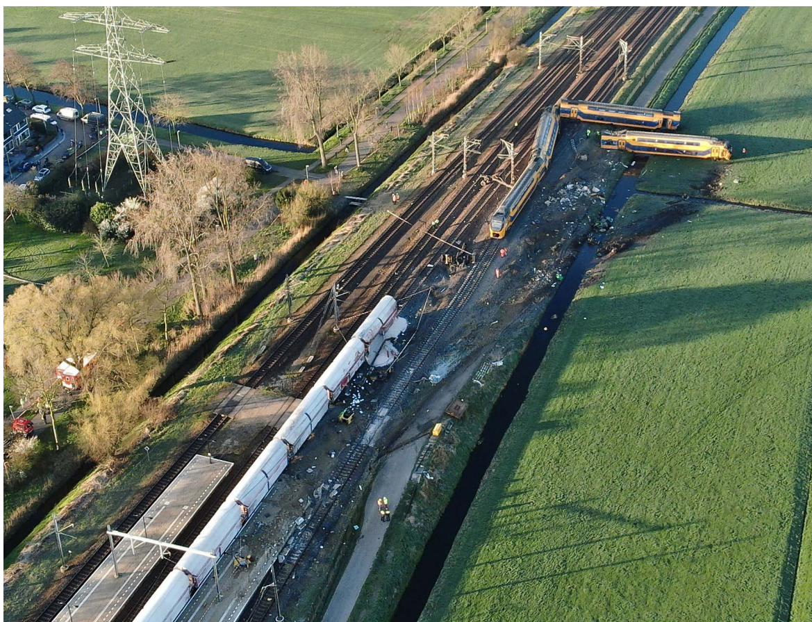
▲ Figuur 1: Foto van de ontspoorde reizigerstrein (bron: politie). Op de voorgrond is nog een deel van het perron van station Voorschoten zichtbaar en de laatste wagens van de goederentrein. In noordelijke richting is de ontspoorde reizigerstrein zichtbaar, de brokstukken van de kraan, het perron en onderdelen van de infrastructuur zijn over de gehele ongevalslocatie verspreid.
