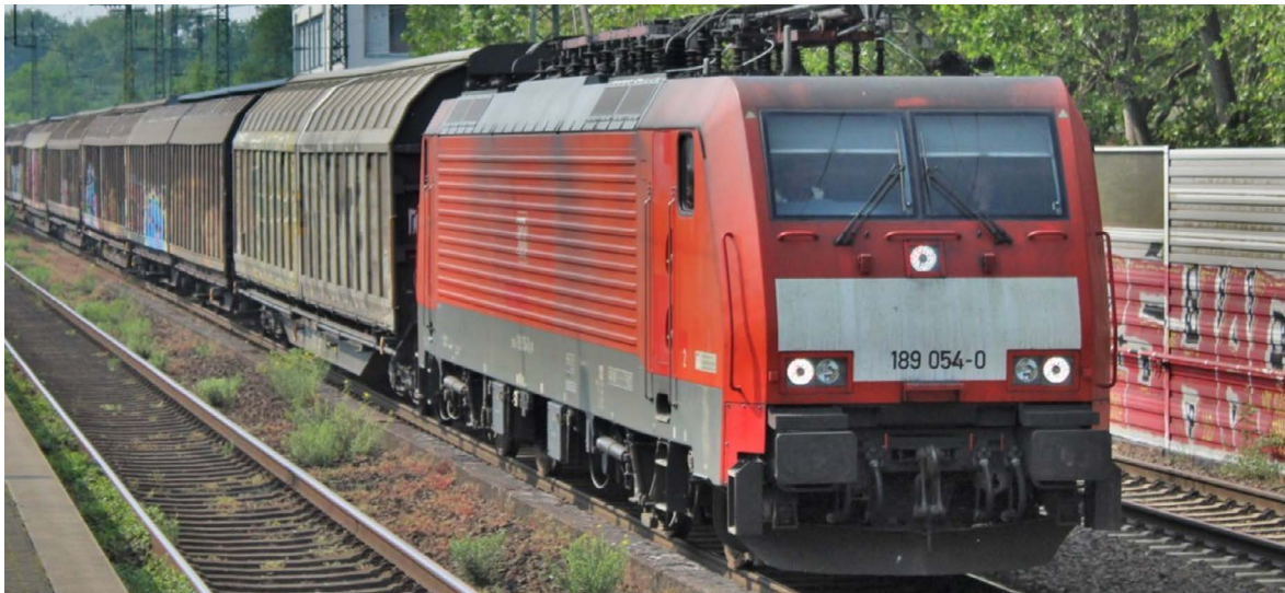
▲ Figuur 42: Voorbeeld van een locomotief, type BR189. (bron: BramW)
