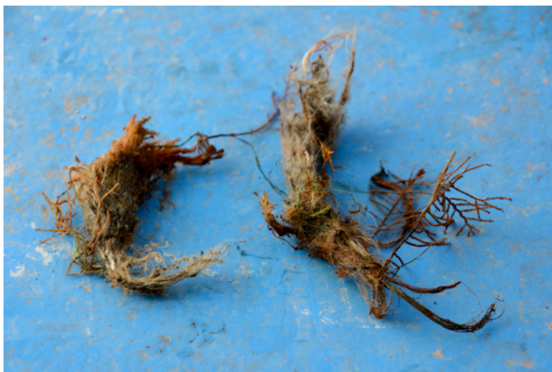
Figuur 20: Touwwerk in stuurboord lensuitlaat. (Bron: Nationale Politie)
