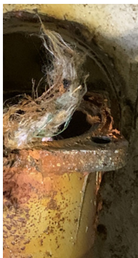
Figuur 20: Touwwerk in stuurboord lensuitlaat. (Bron: Nationale Politie)
