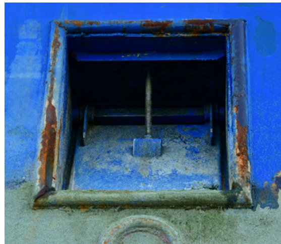
Figuur 5: Visafvalstortkoker – zee-uitgang.
