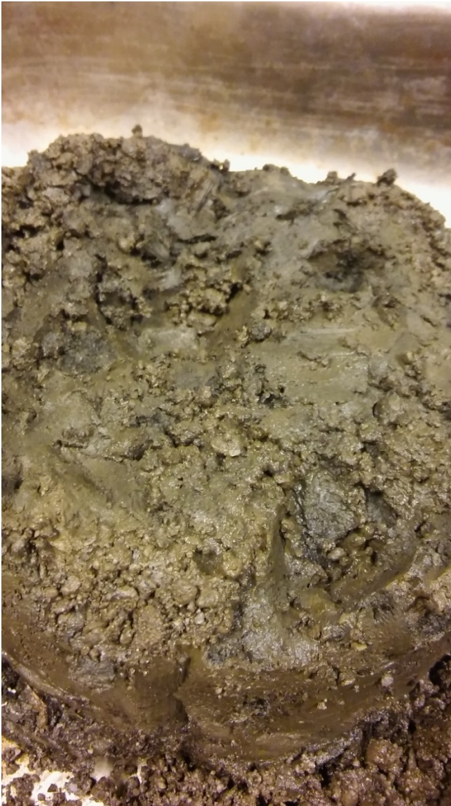
Figuur 3.3 Detail van het oneffen sliboppervlak nadat aan het einde van de test de staalslakken zijn verwijderd..
