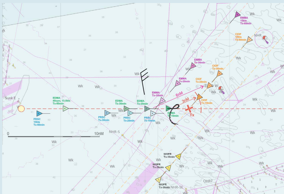
▲ Figuur 14: Het rode kruis in de zeekaart (oriëntatie noord boven) geeft de positie van de mogelijke aanvaring aan tussen de EDMA (groene driehoek) en het andere schip de CIOF (oranje driehoek) indien beide schepen niet handelen. (Bron: Onderzoeksraad voor Veiligheid en NNVO)
