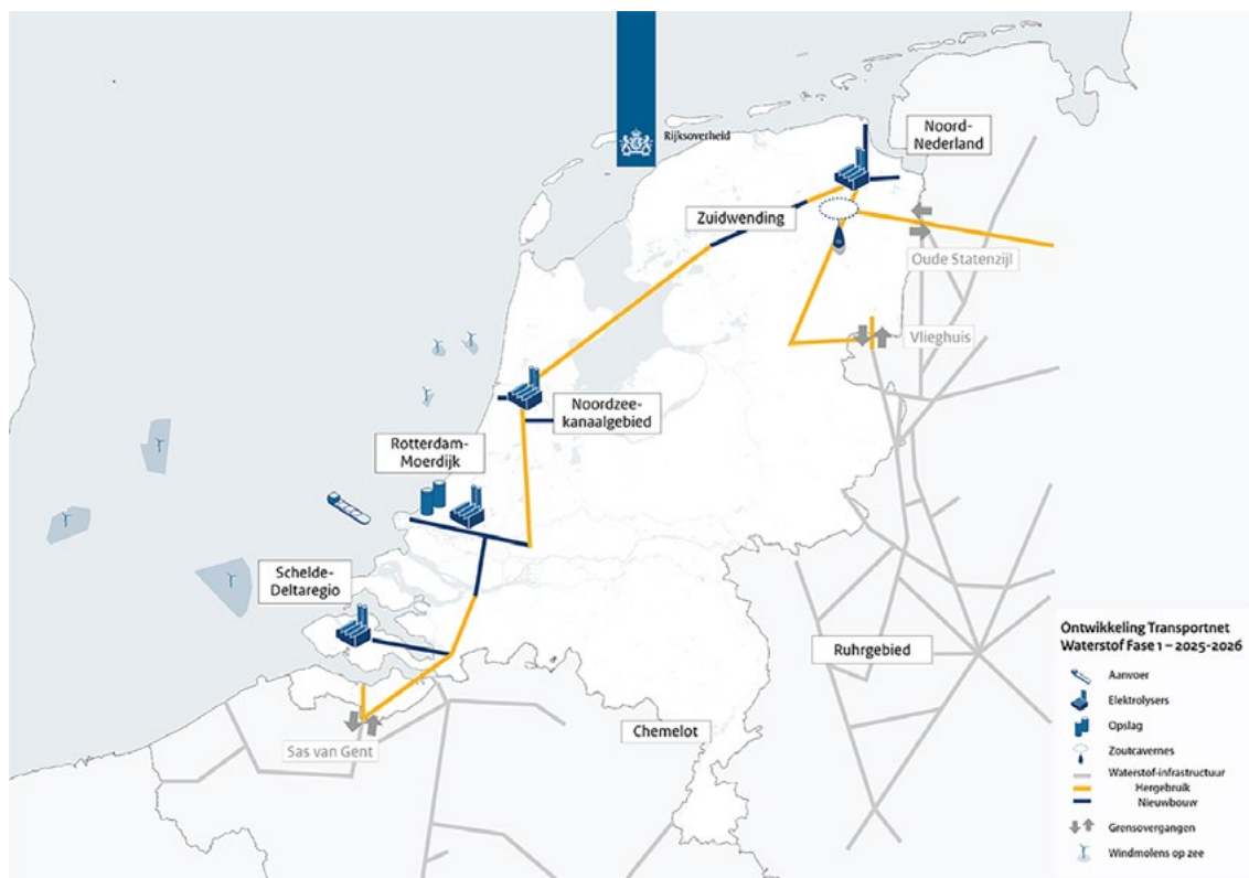
Figuur 4.1. Fase 1, gereed 2025-2026: grote industriële clusters aan de kust en de verbinding met een eerste opslagcaverne.
