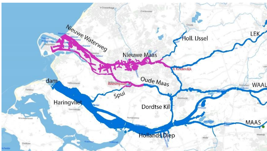
Verspreiding van zoet water (blauw) en zout en brak water (paars) tijdens een lage Rijnafvoer en noordwesterstorm wat resulteert in achterwaartse verzilt van Haringvliet en Hollands Diep.
