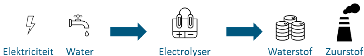
Figuur 2-1: Schematische weergave waterstofproductie door middel van elektrolyse.
