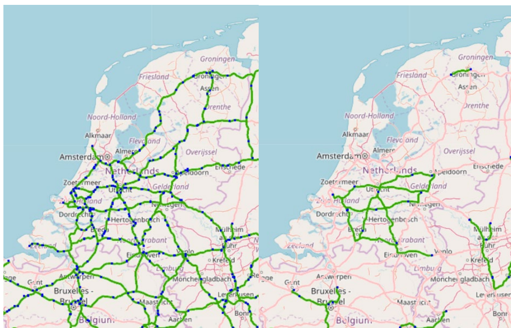
Figuur 11: trajecten die groen zijn hebben minder dan 60 km afstand tussen 2 laadstations met vermogen van 150 kW (links) en 350 kW (rechts). Blauwe stippen geven laadstations met 150 kW (links) of 350 kW (rechts) aan. (bron https://ec.europa.eu/transport/infrastructure/tentec/tentec-portal/map/maps.html GAP-analyse onder kopje alternative fuels)
